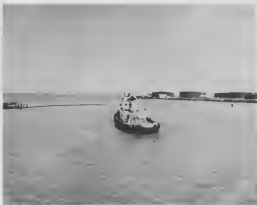
Cu ayudo di un remolcador, un barrera flotante ta ser hala den haaf pa cera e boca di haaf.
